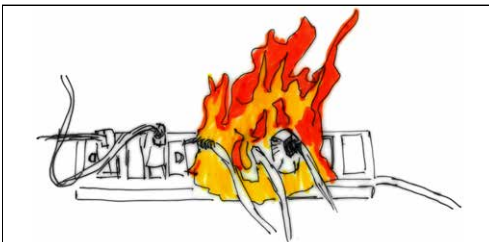
Princípio de incêndio em "régua" de tomadas
