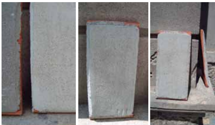
O processo inicia-se com a obtenção da textura, através de amostras-guias em função do traço ou misturas para alcançar a textura e tonalidade mais próxima da original
